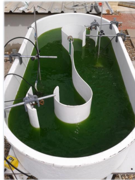
Ensayo en tanques de cultivo de microalgas
