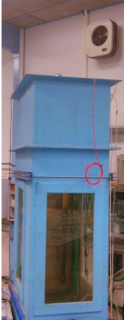
Tanque para ensayos SAE/SOTR con capacidad para 3.000 litros
